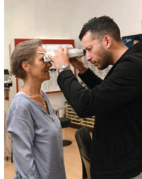
↗ Mit einem Pupillometer nimmt der Augenoptiker Zentriermessungen vor.
